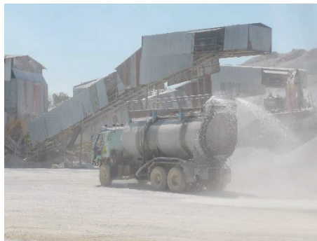
รูปที่ 2-13: การฉีดพรมน้ำบริเวณโรงโม่หิน
