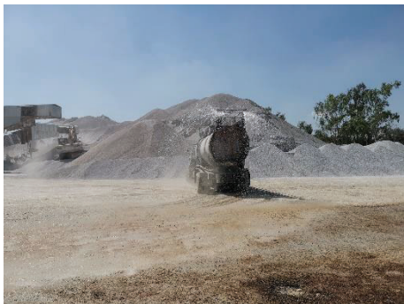
รูปที่ 2-13: การฉีดพรมน้ำบริเวณโรงโม่หิน
