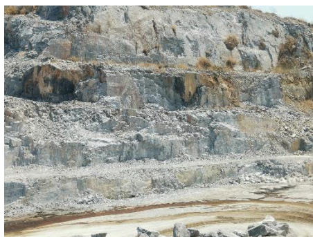
รูปที่ 2-2: การทำเหมืองแบบขั้นบันได
